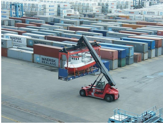
Rys. 2. Kontener typu flat rack unoszący ładunek niewymiarowy
