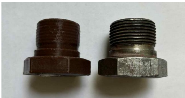
Rys. 7. Element wydrukowany przy użyciu drukarki 3D (po lewej), oryginalny element (po prawej) Źródło: opracowanie własne.
