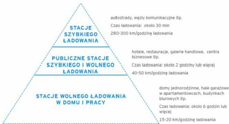
Rys. 4. Piramida hierarchii wyznaczania lokalizacji stacji ładowania
